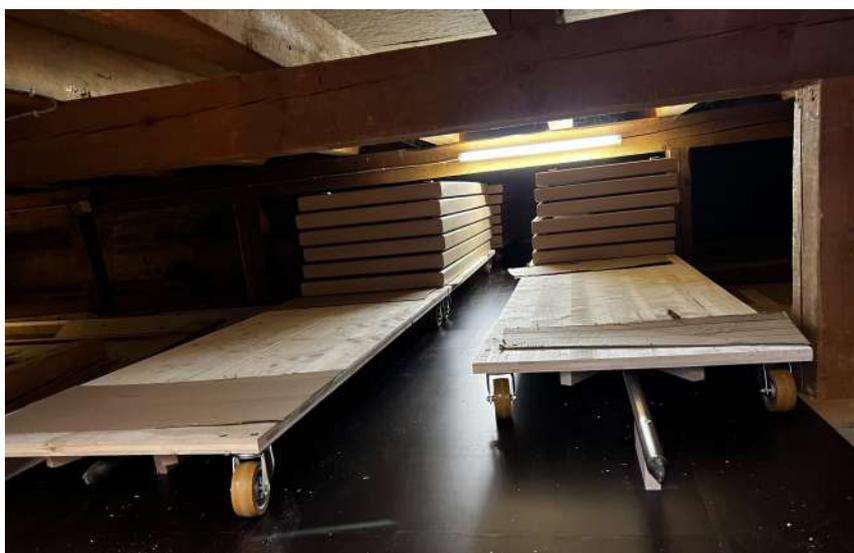
Schienensystem anbringen. Albrecht Warmuth hat diese Vorrichtung entwickelt. So können jetzt alle 48 Tische problemlos unter die Bühne geschoben werden.
